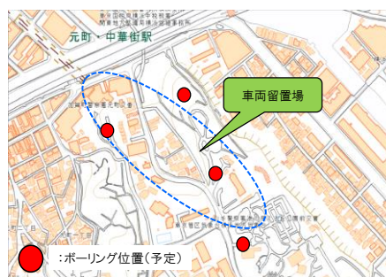
図-1.ボーリング調査予定位置 ※地理院地図に加工
