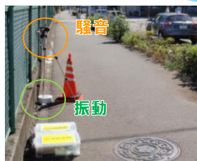
写真-1. 騒音・振動調査
