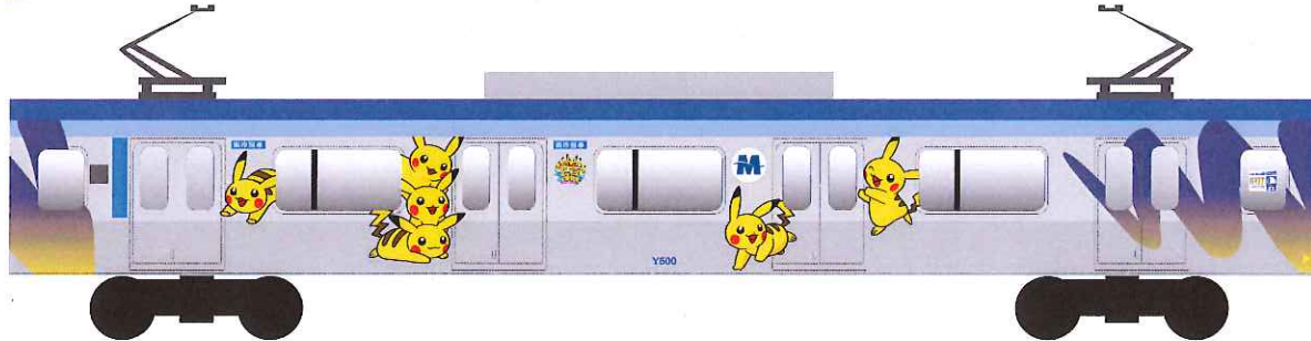
Y500系 2号車 車体サイズ:19500×2290mm(10/100縮小 1950×229mm)
