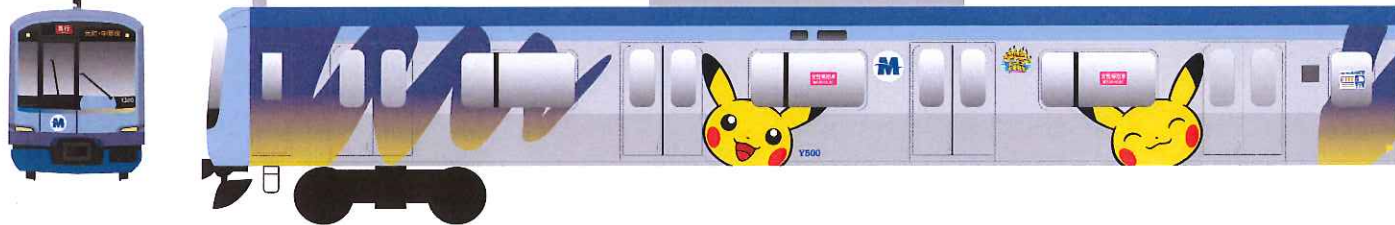
Y500系 6号車 車体サイズ:19500×2290mm(10/100縮小 1950×229mm)
