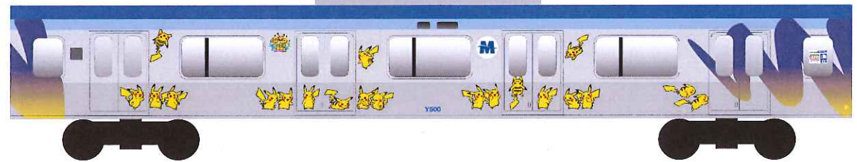
Y500系 3号車 車体サイズ:19500×2290mm(10/100縮小 1950×229mm)
