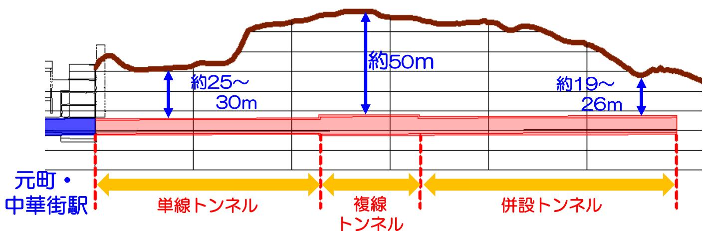
赤で着色されている部分が車両留置場のトンネル計画位置です。また、茶色の線で表されているのが、地表面の位置です。青い矢印は、トンネル上端から地表面までの概ねの距離を示しており、駅近傍の住宅地付近で約25m～30m、港の見える丘公園付近で約50m、トンネル終端部で約19～26mとなっています。
