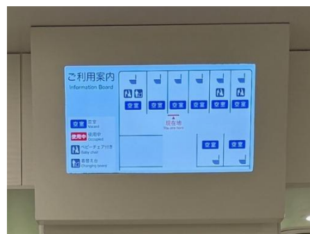
在室表示モニターによる空き状況の確認
